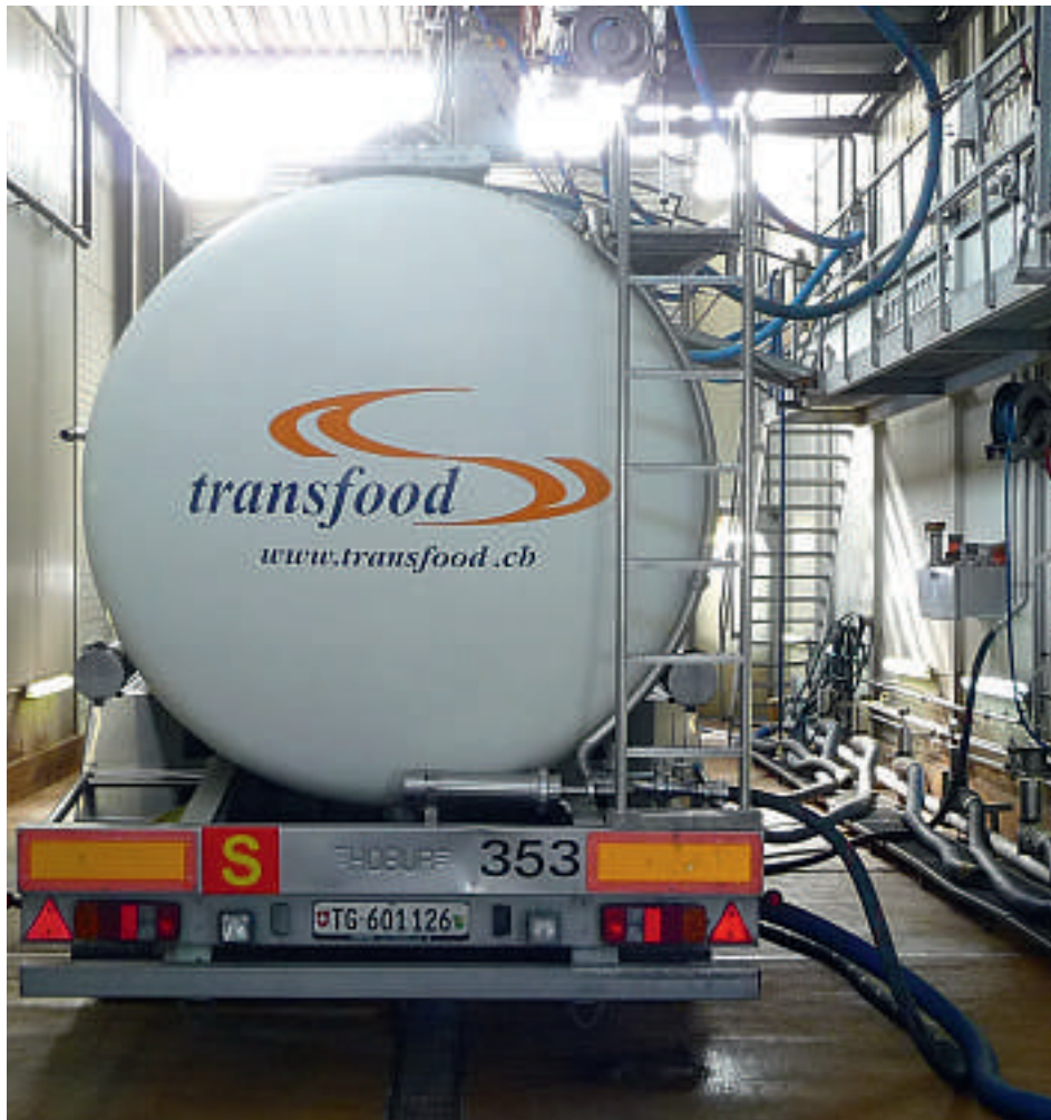
Zur Vermeidung von Kontaminationen durchlaufen Tankfahrzeuge und IBC eine auf die Verschmutzung abgestimmte CIP-Reinigung aus dem Hause der Halag Chemie
