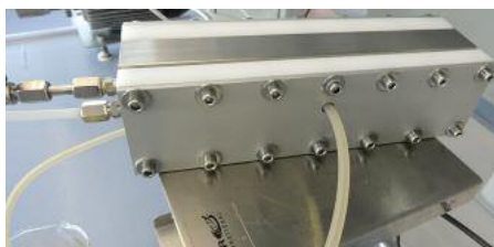
Membranfiltrationsanlage im Labormassstab zur Optimierung der Reinigungszyklen.
