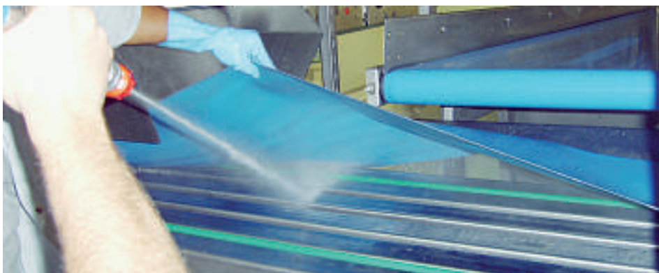
Bei Frigemo wird nicht nur die Bandoberfläche, sondern auch die Unterseite gründlich gereinigt
