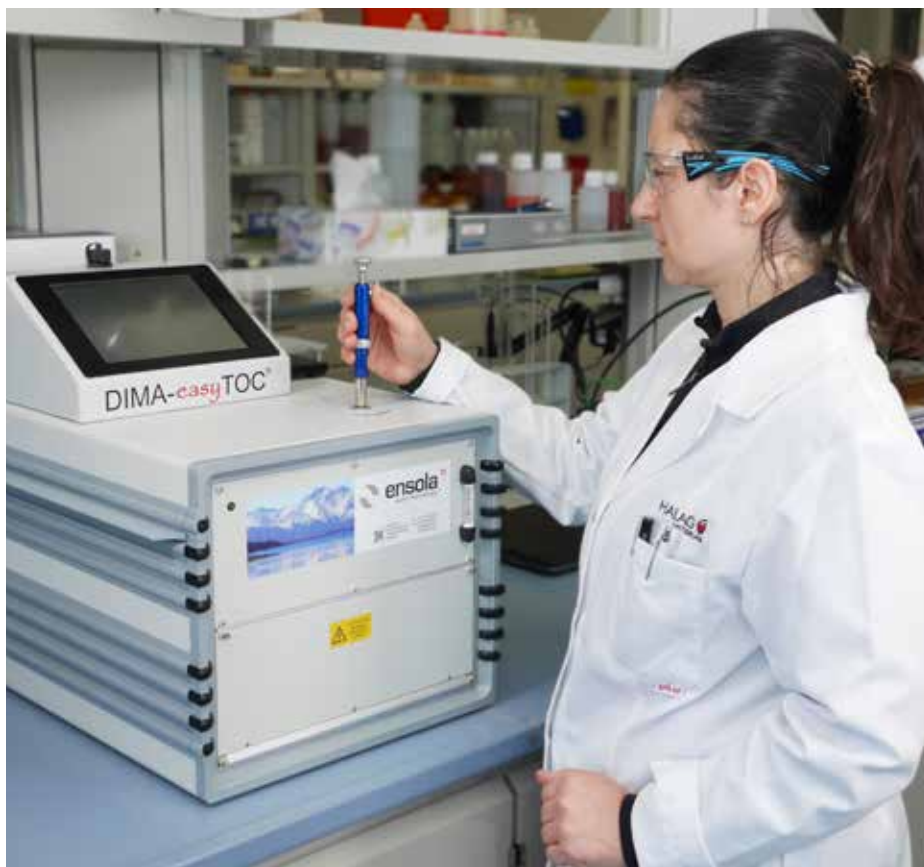
TOC Analyse des Spülwassers im Halag Labor. (Foto: © Halag Chemie AG)
