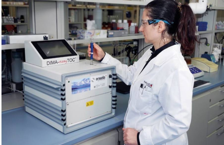
TOC-Analyse des Spülwassers im Halag Labor. (Bilder: Halag Chemie AG)
