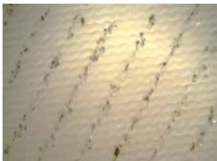
Abb. 6: Metallspäne und Pumpenabrieb auf einer Membran
