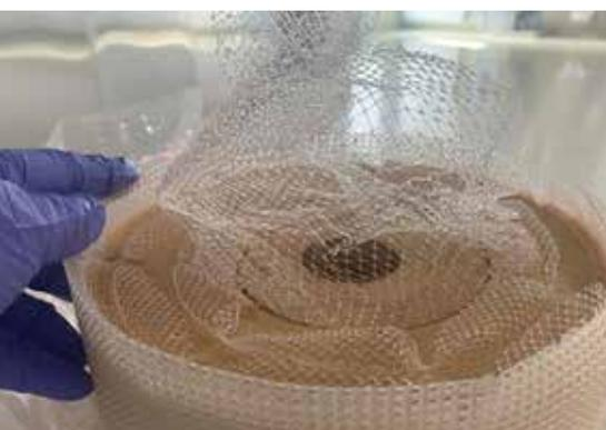
Abb. 2: Indiz für falsche hydraulische Bedingungen wie Differenzdruck / Druckschlag; führen zu Teleskopierung/Spacer Verschiebung
